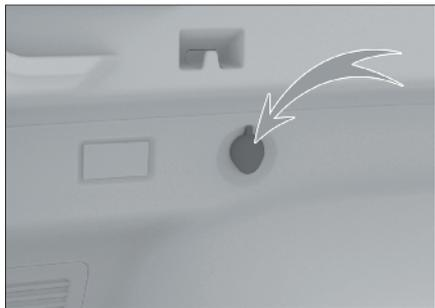
При включенном режиме питания откройте крышку для использования этого источника питания. Этот источник питания обеспечивает питание с напряжением 12 В постоянного тока (10 А) для устройств мощностью не более 120 Вт.
