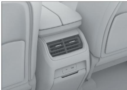
Передвиньте рычажки в центральной части дефлектора, чтобы отрегулировать направление воздушного потока.
