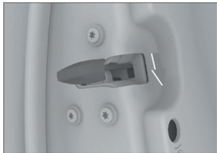
Чтобы заблокировать дверь, вставьте механический ключ в замочную скважину аварийного замка, поверните его в крайнее нижнее положение, а затем закройте дверь.
