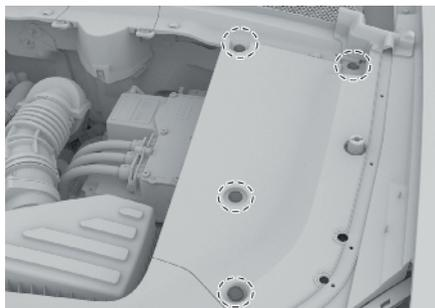
Затем снимите крышку блока предохранителей, чтобы получить доступ к положительной вспомогательной клеммной колодке. (▷Стр. 280)
